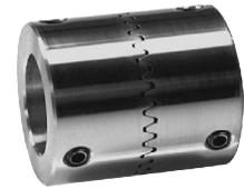
ermöglicht eine formschlüssige Verbindung zwischen zwei Wellen selbstzentrierende Verbindung, die bei Wellenstillstand getrennt oder verbunden wird
